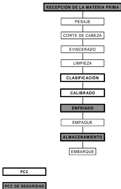
Figura Ejemplo de flujograma de proceso de pescado enfriado refrigerado
